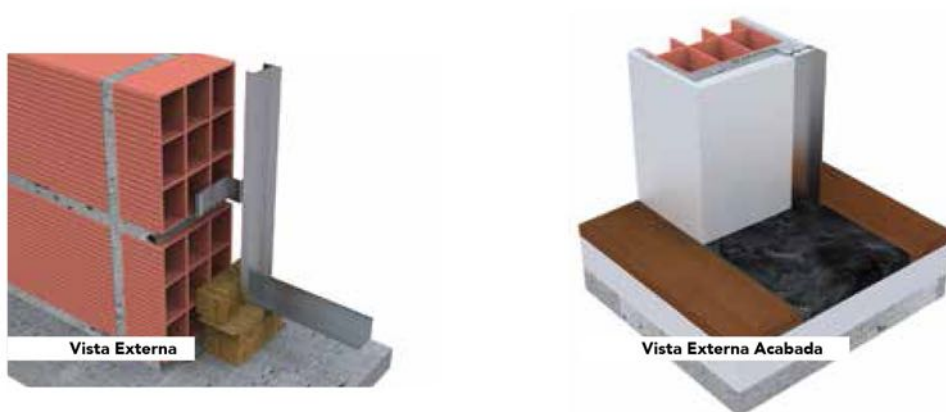
Instalação do contramarco.
