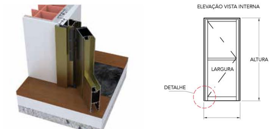
Contramarco instalado com porta e arremates.
